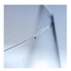
Extrudierter Polymerfilm mit sichtbaren Defekten
