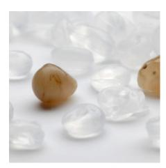
Prüfbare Pellets/Polymere mit Defekten
